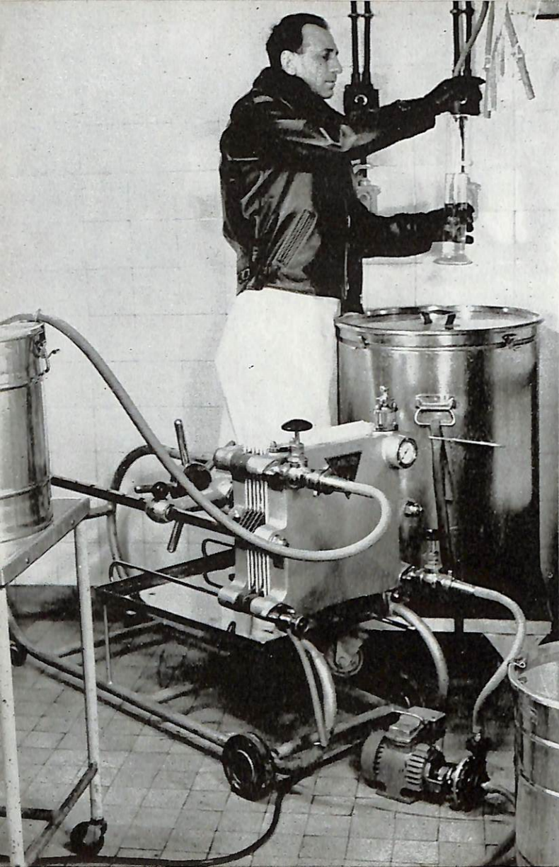
Une phase de la préparation des gamma-globuline : filtration stérile au filtre Zeiss.
